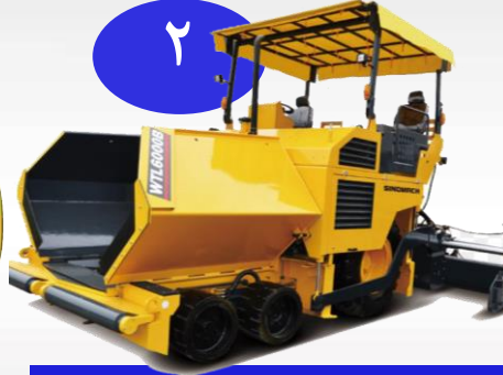
٢ فرادة اسفلت Road Machine Pavement
